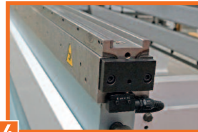
PIEGASCHIACCIA PNEUMATICO incorporato nella tavola e gestito da CNC con finecorsa di sicurezza
