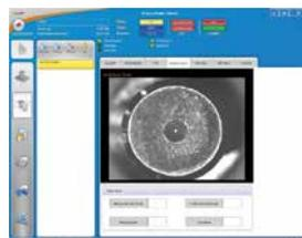
Nuovo dispositivo dedicato al monitoraggio della posizione e dello stato dell'ugello tramite una videocamera. In questo modo, grazie al controllo dello stato dell'ugello e delle sue condizioni, è possibile aumentare l'efficienza e ridurre i tempi morti. L'opzione sfrutta un part program dedicato per il corretto posizionamento della lente e dell'ugello.
