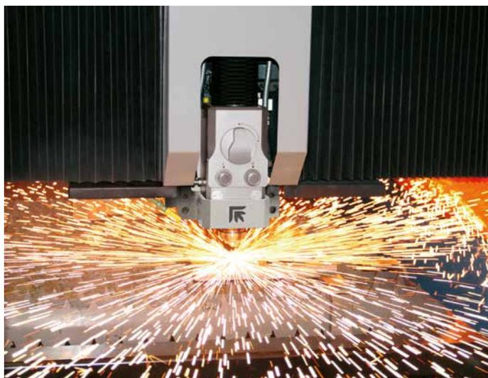
La testa laser per macchine CO<sub>2</sub> di Prima Power è dotata di un sistema di protezione dagli urti accidentali denominato SIPS e di un asse a controllo numerico per la gestione della posizione focale indipendente dall'asse Z.
