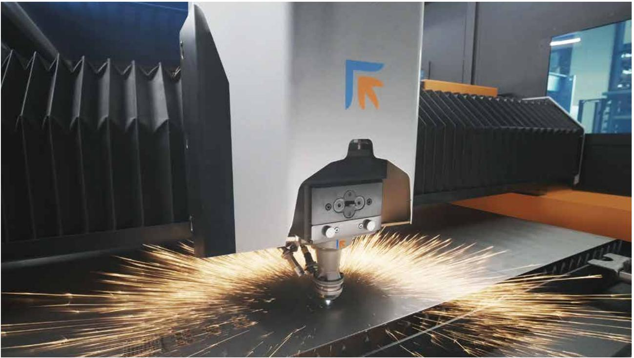
Dinamiche ai vertici della categoria per garantire tempi ciclo ridotti con un'eccellente qualità di taglio. Laser Genius+ può lavorare con alti livelli di qualità un'ampia gamma di materiali fino a 30mm e può essere dotata di generatore laser con potenze che vanno da 2 a 10 kW.
