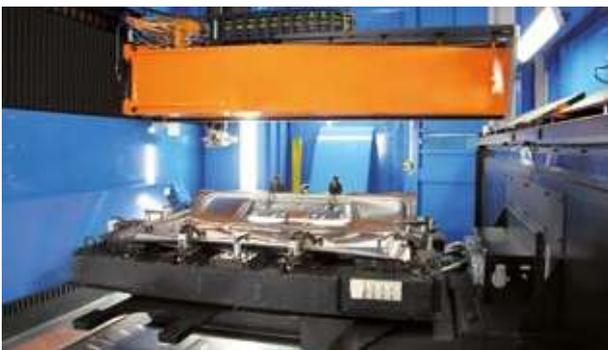
I motori lineari sugli assi principali e i motori diretti con scale ottiche sulla testa di messa a fuoco consentono una dinamica e una precisione superiori.
