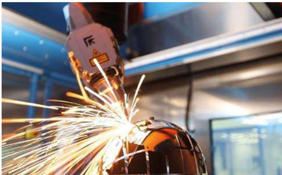
La tecnologia del laser fibra, utilizzata nelle macchine laser 3D di Prima Power, permette questa flessibilità, pur garantendo alti livelli di produttività, qualità ed efficienza con bassi requisiti di manutenzione.
