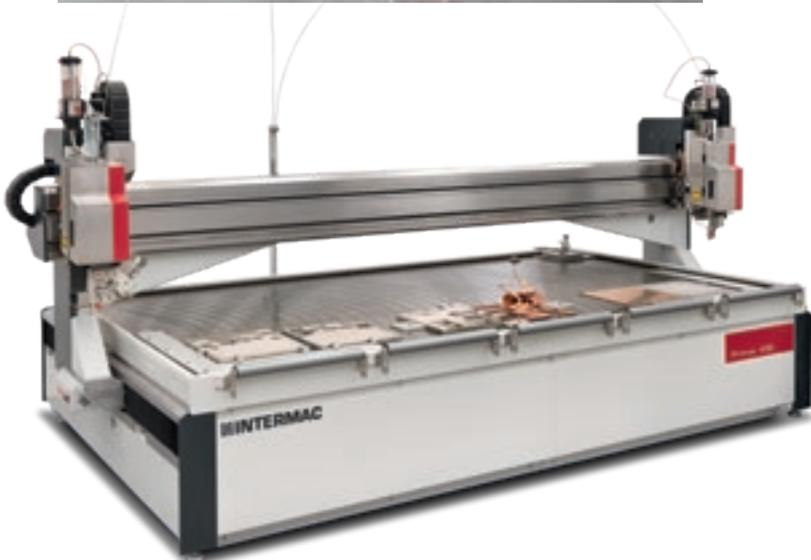
Primus offre la possibilità di processare una vasta gamma di materiali: pietre sintetiche, naturali, materiali ceramici e vetro.
