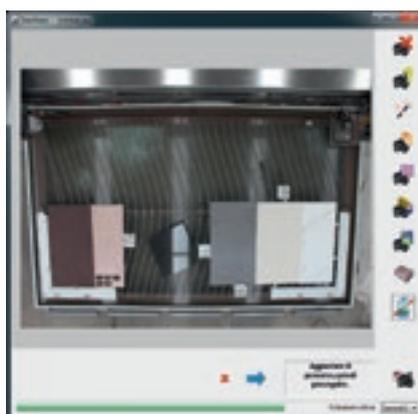
Il sistema opzionale di rilevamento fotografico è particolarmente indicato per lavorazioni a macchina aperta dove risulta importante seguire la morfologia della pietra naturale. Un altro vantaggio riguarda la possibilità di ottimizzare al massimo anche lastre già parzialmente utilizzate, oppure di ottimizzare lastre scartando eventuali area dove si presentano difetti del materiale.
