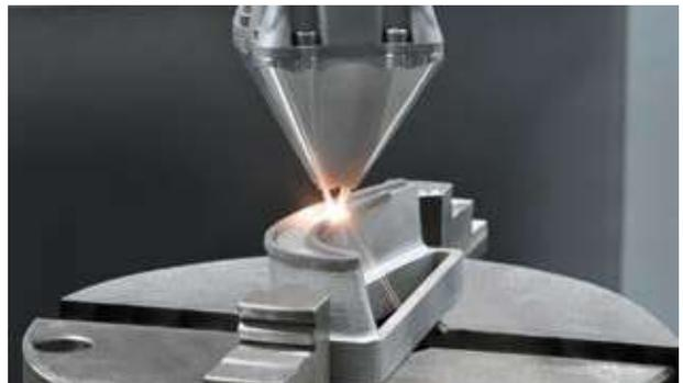
Bordo della pala di turbina in fase di costruzione attraverso il getto di 4 ugelli additivi.
