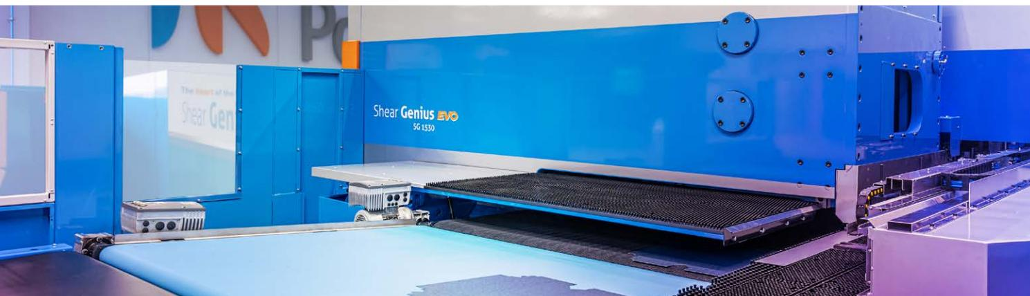
La cesoia angolare di Prima Power è estremamente rapida. L'altezza programmabile della lama e la regolazione automatica della profondità della corsa ottimizzano la cesoiatura. La velocità della lama viene selezionata automaticamente per ottenere la massima velocità. Insieme alle modalità di taglio automatico, questo ottimizza la velocità di funzionamento.
