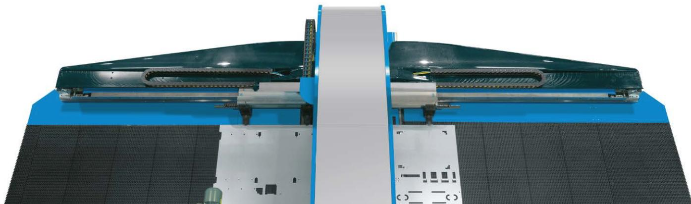
La Shear Brilliance, completamente servoelettrica, è dotata di una tecnologia ad azionamento lineare per il posizionamento del foglio e porta la velocità di produzione e la produttività a un nuovo livello. I fogli vengono preposizionati mentre la macchina è in funzione, riducendo drasticamente i tempi di carico.
